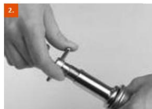
Durch Rechtsdrehen des Griffs wird die Schubstange in den Extraktor gedrückt und dieser somit aufgespreizt.
